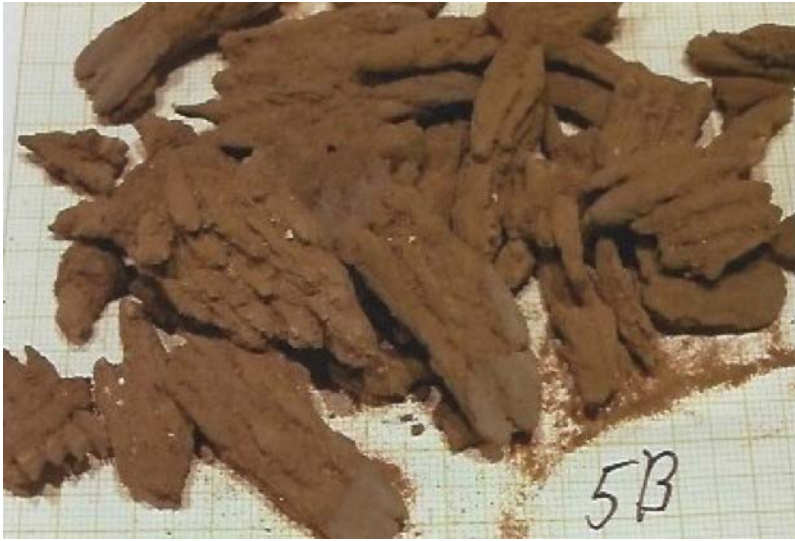
Bild 3 a: Belagsprobe von ÜH2 (Januar 2016) SiO 2 : 11,9%, Al 2 O 3 : 2,7%, Fe 2 O 3 : 3,4%
