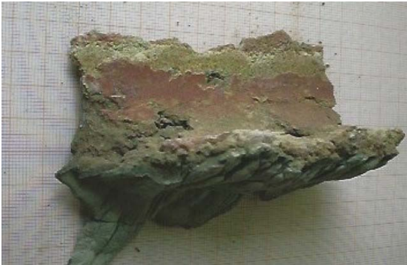
Bild 3 b: Belagsprobe von ÜH2 (April 2012) SiO 2 : 4,6%, Al 2 O 3 : 0,9%, Fe 2 O 3 : 2,0%
