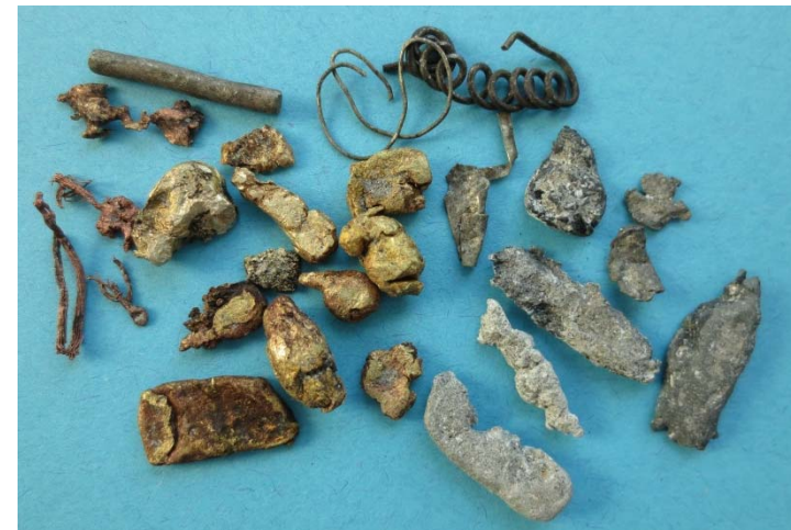
aus gemahlener Probe abgesiebte Partikel: Cu, Zn, Pb, Ni (-Legierungen)
