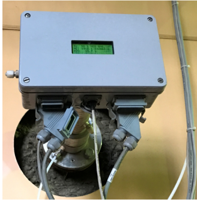
Abbildung 24: Anwendung der kombinierten HCl-H 2 O-Messung im GKS (linke Seite) und prinzipieller Aufbau der Messung (rechte Seite) [19]
