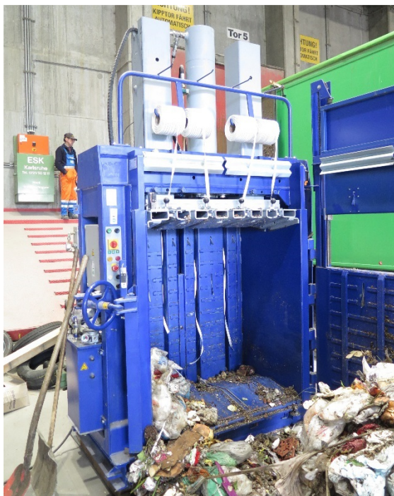
Abbildung 5: Portalpresse nach einem Pressversuch mit Brennstoff Hausmüll
