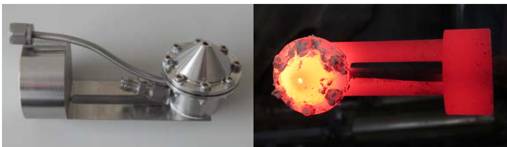
Abbildung 2: Zusammengebaute Sonde vor und direkt nach dem Einsatz bei 1250°C.
