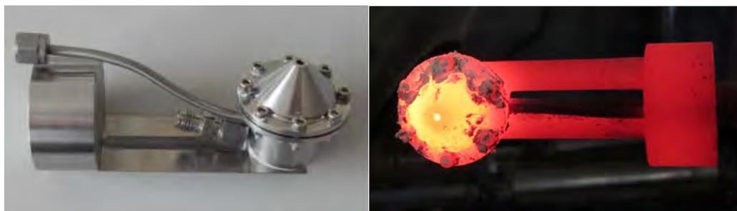
Abbildung 5: Zusammengebaute Sonde vor und direkt nach Einsatz bei 1250°C.
