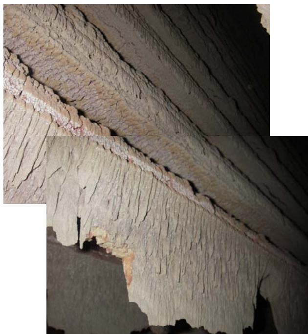
Abbildung 11: Reale Beläge eines Überhitzers am Ende der Reisezeit
