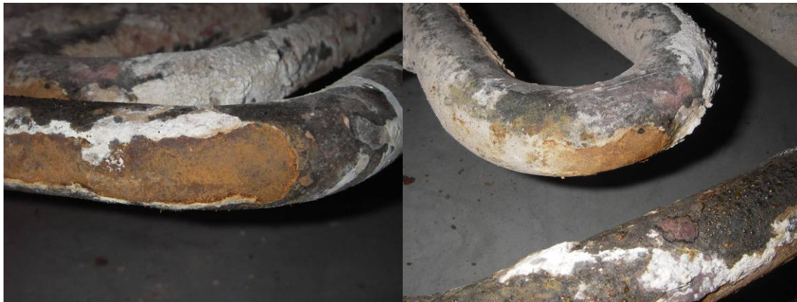
Abbildung 5: Thermisches Spritzen Endüberhitzer nach 22.500 Stunden
