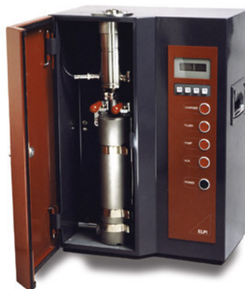
Abbildung 7: Electronic Low Pressure Impactor (Dekati Oy, Tampere) und Foto von beladenen Impaktionsplatten
