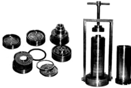
Abbildung 6: Berner-Impaktor: Hülse (links), Impaktorkaskade in der Montage-Vorrichtung (rechts daneben) und einzelne Impaktorstufen und Distanzringe (rechts)
