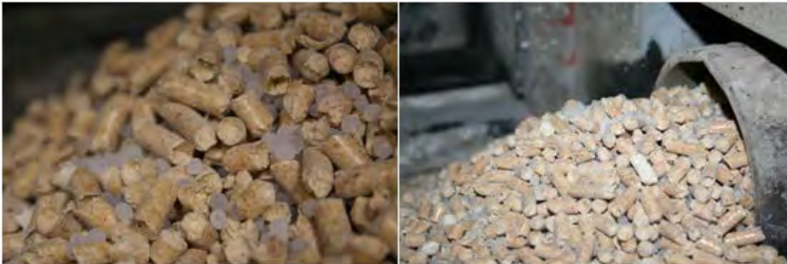
Gemisch aus Holzpellets und nanoTiO 2 -haltigem Kunststoffgranulat bei Förderversuch in Technikumsanlage
