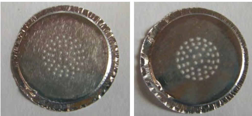
Impaktorstufen 6 und 7 nach der erneuten Probemessung mit angepasster Messzeit am GKS, Messstelle nach Zyklon
